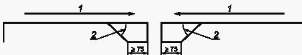
1 — направление закрывания створок дверей; 2 — угол \leq 45^\circ
